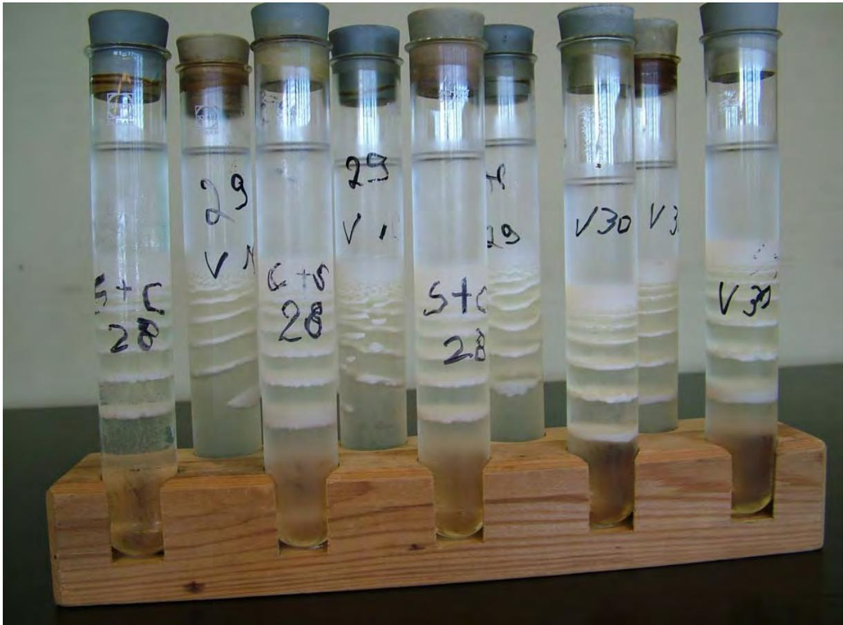
Abb. 5: Magnesiumhydroxidringe in Gelatine-Gelen. 28, 29, 30 entsprechend 2, 3, 4 g  $\text{MgSO}_4 \cdot 7\text{H}_2\text{O}$  im Gel deponiert.
