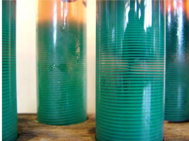
Abb.8: Feine Ringe von Cobalt(II)-hydroxid in einem Gelatine-Gel im Detail.
